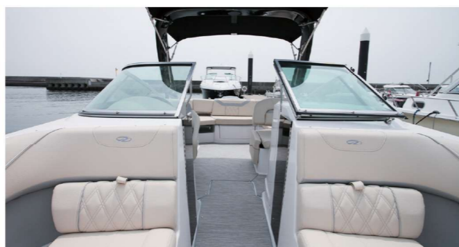
コクピットにエンジンルームがないアウトボードモデルゆえ、コクピットは余裕の広さ。7人が座ることができるU字ソファは、ポートサイドのバックレストを立てると2人掛けのベンチシートに早変わりする。マリンスポーツに必要なカップホルダーは計14か所。フロアの下にはロングストレージがあり、ボードなど長尺物の収納にも困らない。
