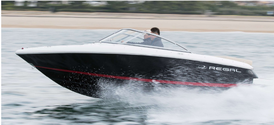
ドライビングポジションはカーライク。フルオープンなスポーツカーを操るような感覚で楽しい。自然なバンクや、安定した姿勢により、跳ね回る必要もなく、ドライビングを楽しむことができる。写真からもわかるように、リバースチャインにより、飛沫は下に落とされ、コックピット内はともドライだ。
