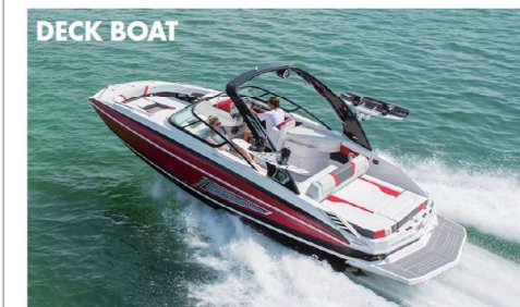
DECK BOAT 27 FasDeck RX 全長 8.3 m 全幅 2.5 m 喫水 0.9 m 重量 2.48 t 燃料タンク 286 L 清水タンク 45 L エンジン Volvo V8 380 DP Catalyst (380HP)
