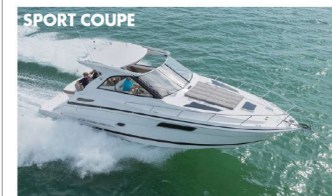
SPORT COUPE 35 SPORT COUPE 全長 11.23 m 全幅 3.45 m 喫水 0.9 m 重量 5.85 t 燃料タンク 598 L 清水タンク 189 L エンジン 2 x Volvo V8 380 OceanX Catalyst EVC Joystick (2 x 380HP)
