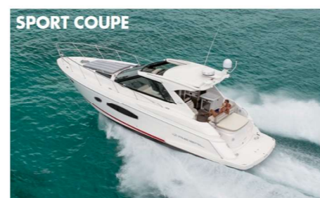
SPORT COUPE 42 SPORT COUPE 全長 12.9 m 全幅 4 m 喫水 1 m 重量 9.29 t 燃料タンク 1,044 L 清水タンク 264 L エンジン 2 x Volvo D6 Diesel IPS 500 (2 x 370HP)
