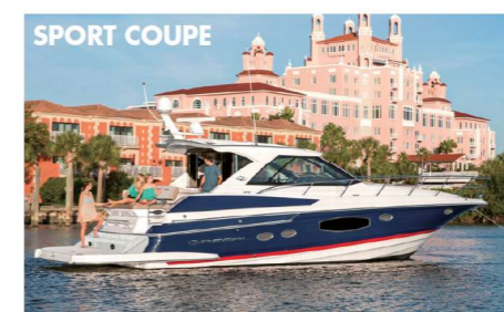
SPORT COUPE 46 SPORT COUPE 全長 14.02 m 全幅 4.27 m 喫水 1.07 m 重量 11.48 t 燃料タンク 1,242 L 清水タンク 382 L エンジン 2 x Volvo D6 Diesel IPS 600 (2 x 435HP)
