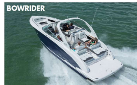
BOWRIDER 3200 全長 9.8 m 全幅 3.2 m 喫水 0.9 m 重量 4.45 t 燃料タンク 568 L 清水タンク 110 L エンジン Volvo V8 430 Catalyst EVC Joystick (430HP)
