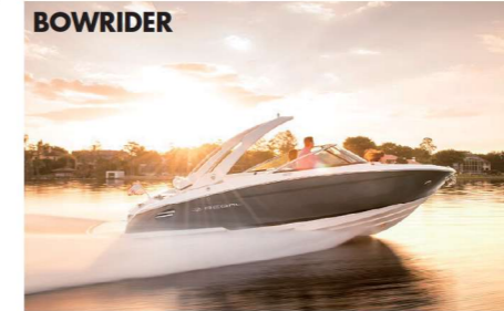
BOWRIDER 2800 全長 8.6 m 全幅 2.7 m 喫水 0.97 m 重量 2.97 t 燃料タンク 409 L 清水タンク 68 L エンジン Volvo V8 430 DP Catalyst EVC (430HP)
