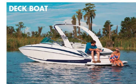
DECK BOAT 27 FasDeck 全長 8.3 m 全幅 2.5 m 喫水 0.9 m 重量 2.43 t 燃料タンク 286 L 清水タンク 45 L エンジン Volvo V8 380 DP Catalyst (380HP)
