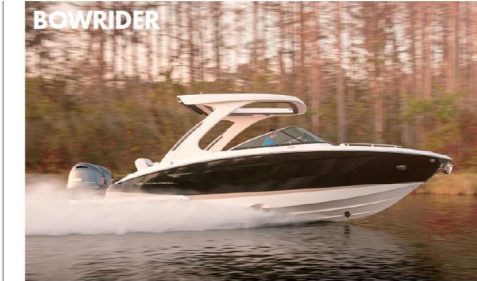
BOWRIDER 29 OBX 全長 8.6 m 全幅 2.7 m 喫水 0.78 m 重量 2.97 t 燃料タンク 560 L エンジン 2 x YAMAHA I4 2.8L F200XCA (2 x 200HP)
