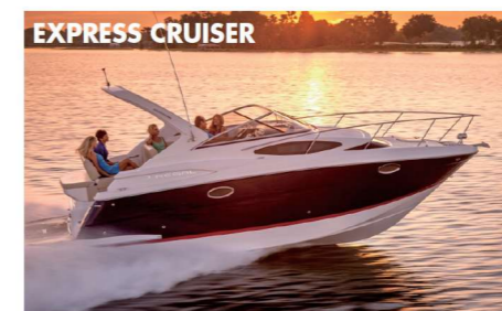
EXPRESS CRUISER 30 Express 全長 8.9 m 全幅 2.9 m 喫水 1.0 m 重量 4.26 t 燃料タンク 379 L 清水タンク 132 L エンジン 2 x Volvo V6 240 DP (2 x 240HP)
