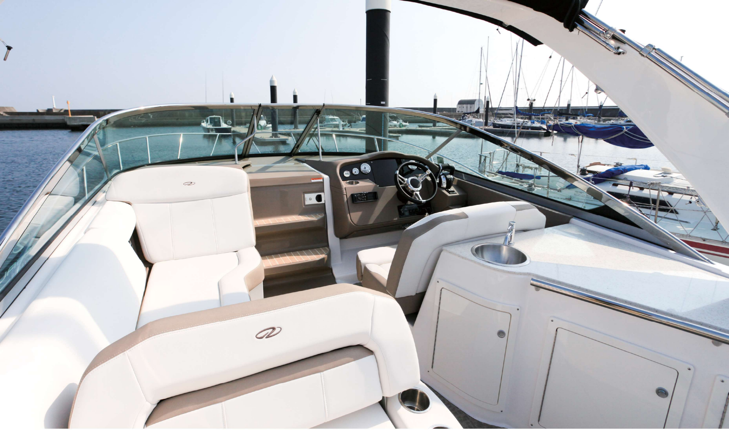
キャビンへのアクセスドアはパウデッキへのステップも兼ねている。ヘルム後部はウェットバーを備えたカウンター。派手さは少ないが見やすいヘルムステーション。ステアリングは操船位置に合わせて角度を変更可能だ。一体型のスイミングプラットフォームはかなり広い。
