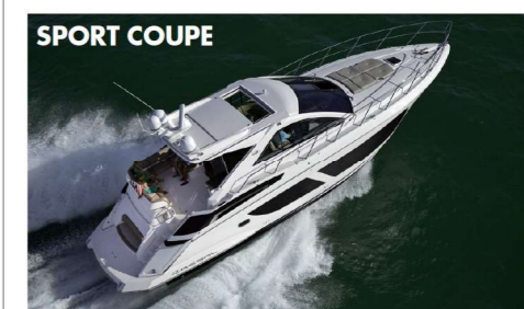
SPORT COUPE 53 SPORT COUPE 全長 16.2 m 全幅 4.67 m 重量 16.33 t 燃料タンク 1,703 L 清水タンク 379 L エンジン 2 x Cummins Diesel 6.7L Zeus (2 x 550HP)
