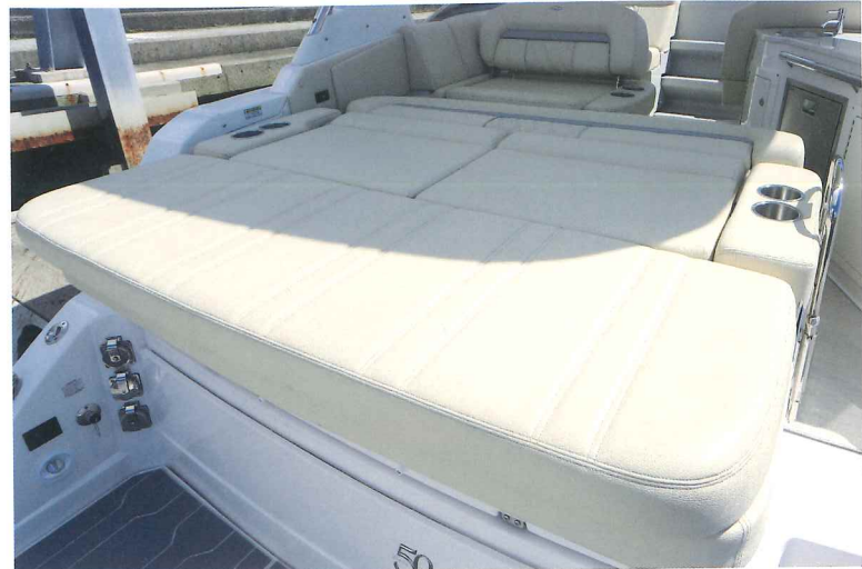
最船尾側のシートは前後にスライドでき、また、バックレストを倒す方向や角度にもバリエーションがあるため、さまざまな形態をとることが可能となっています
