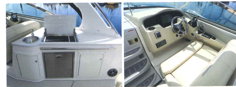
(左) コクピット船尾側右舷には、標準状態でウエットバーが備わりますが、オプションの冷蔵庫やグリルを装備すれば、ちょっとしたエンターテインメントセンターを構築できます (右) ヘルムステーションは簡単なグラスコクピット化がなされています。ジョイスティックは汎用のオプティマス360、となりににはハウスラスターのコントローラーが備わります
