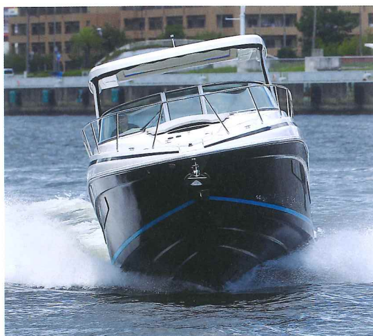
中間的な速度なのですが、明確なリバースシアードで船首のデッキ面が下がっているため、前方視界はとても良好。もちろん、基本的な航走姿勢が適切だというのも理由です
