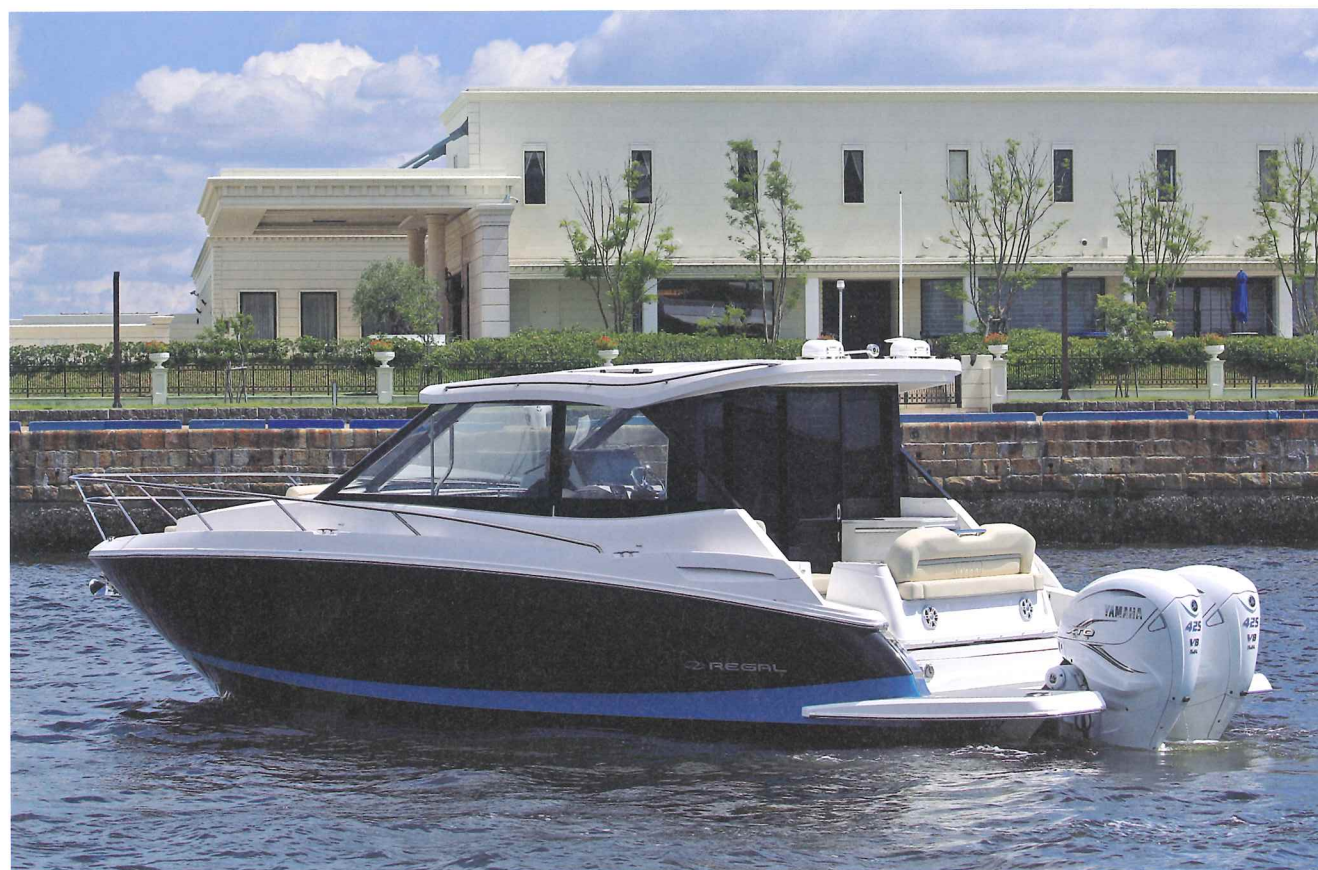
大柄な船外機の2基掛けですが、F425自体がステアリング機構を内蔵しているため、船外機艇ならではの新しい機能美のようなものも感じさせます
