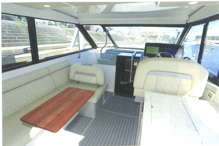
ハウス内。床は船尾のコクピットからずっと同じレベルでフルフラット。こういったフラットな床は、以前からリーガルのエクスプレスクルーザーの特徴の一つでした
