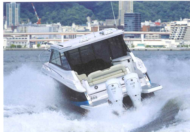
旋回途中で波を拾ってスプレーを上げていますが、このスプレーはスーッとハルから離れていくため、デッキハウスの窓が濡れることはほとんどありませんでした
