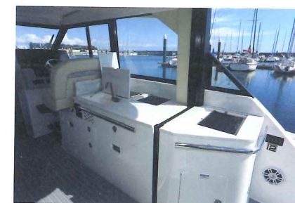
コクピットのグリル部分とハウス内のギャレーとは一直線の配置。スライディングドアのないタイプなら一体化されますが、ドアのあるタイプはその部分のガラスが昇降式です
