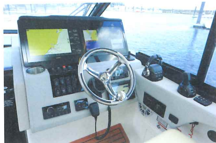
ヘルムステーションはグラスコックピット化がなされており、2基のディスプレイで情報を表示。エンジン関係については、右下のコマンドリンク専用モニターでも表示されます
