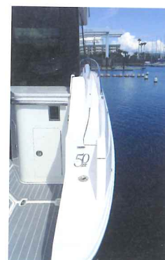
狭いながらもデッキ端がトール状に立ち上げられたサイドデッキが備わります。一応、船首尾間を行き来できますし、フェンダー着脱などの際にいろいろか役立つでしょう
