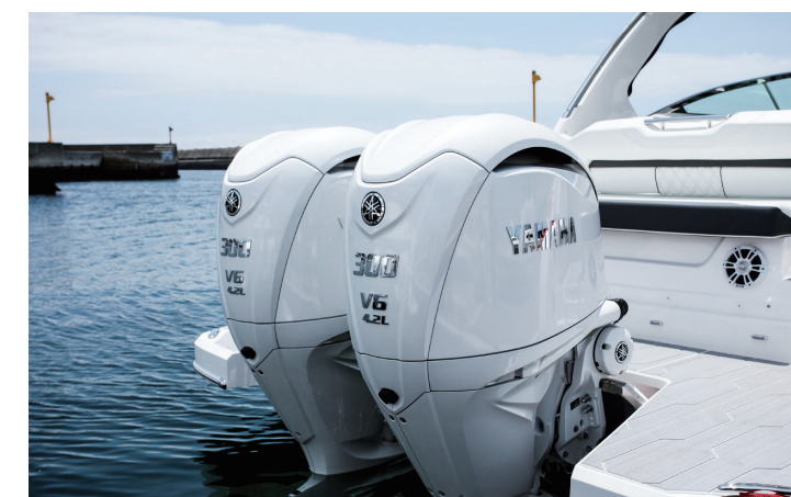
パワートレインはツインYAMAHA V6 F300。5,900rpmまで回し44ノットがこの日のトップスピード。40ノットまで落とせば非常に安定感のある走りを見せる。
