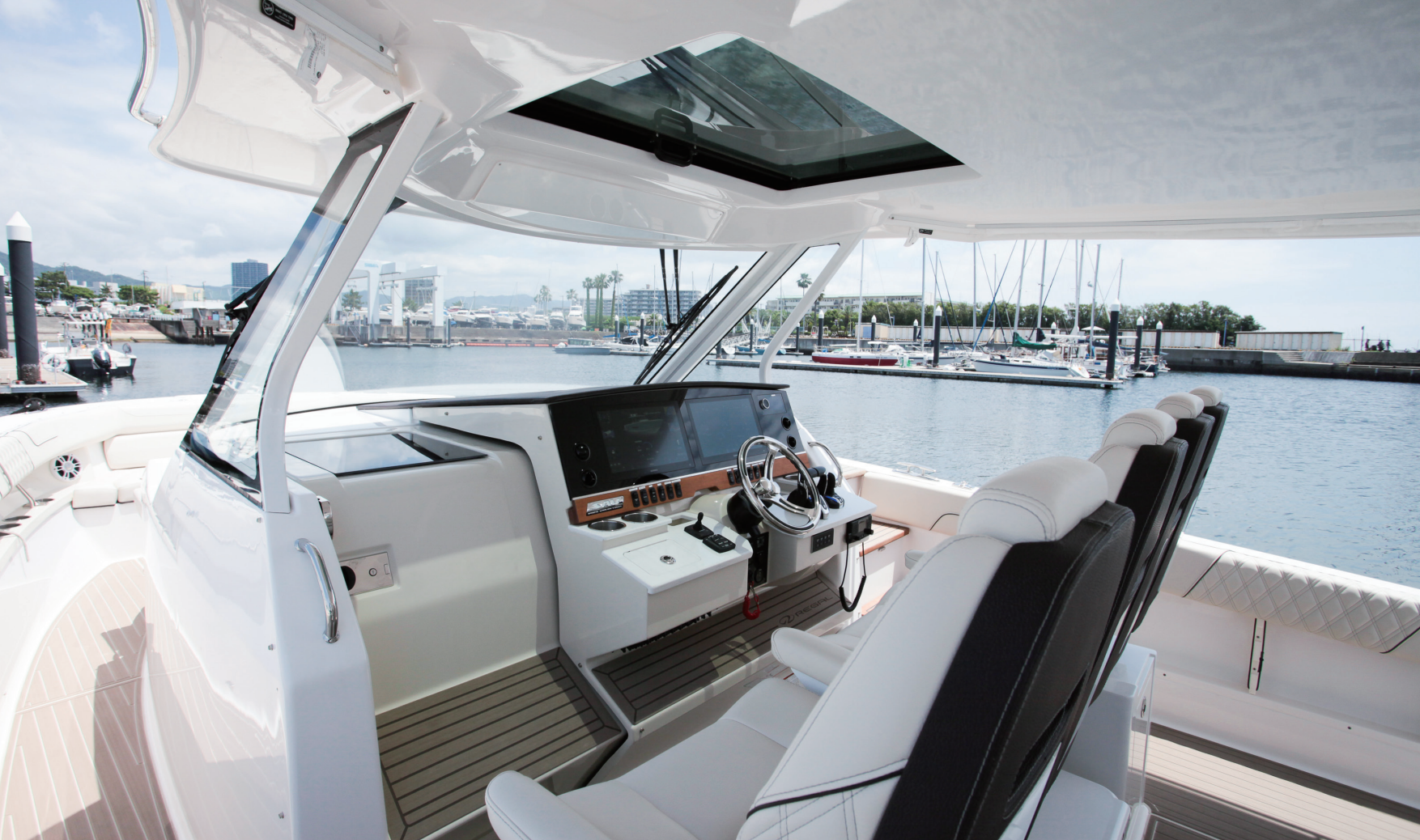
クワッドシートの右から2番目がドライバーシート。見やすい大型タッチスクリーンを中心に、各種スイッチやコントロール系が並ぶ。ハードトップはサンルーフ付きだ。
