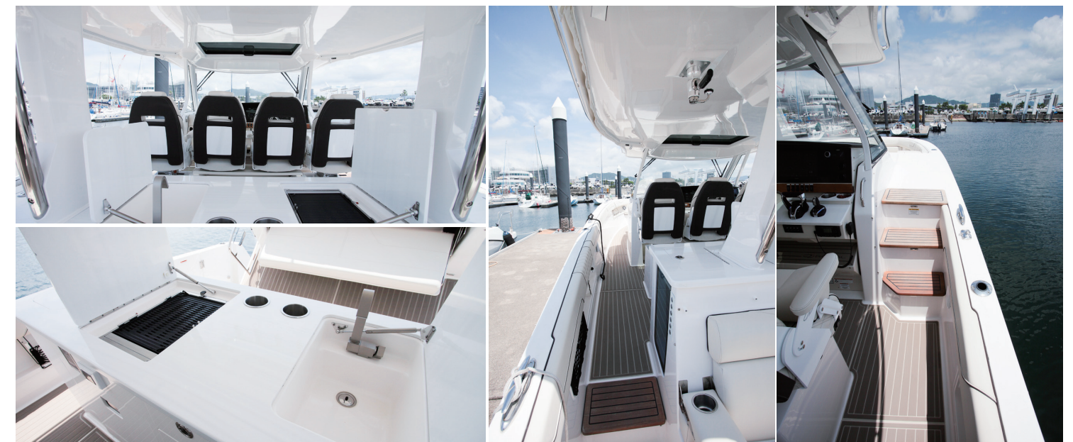
シンク、バーベキューグリル、ライブウェルなどが備わるリギングステーション。左右非対称の右舷側はハイドックアクセスと呼ばれる特徴的なデッキ構造となっている。
